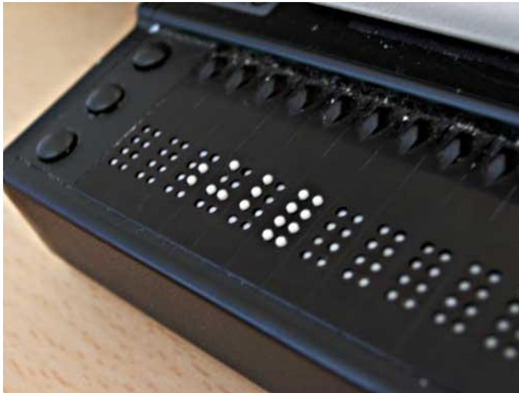
Bild: Braillezeile als Ausgabegerät für Menschen mit einer Sehbehinderung
